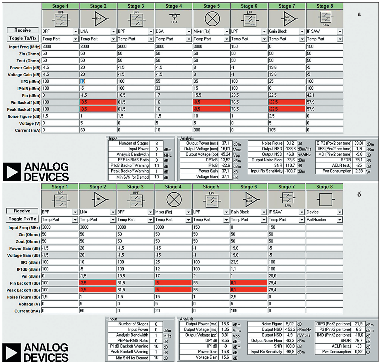
▲ Рис. 6. Расчет бюджета для двух вариантов приемного тракта: а) приемный тракт на базе микросхемы HMC1090LP3; б) приемный тракт на базе микросхемы TE-RX1000
