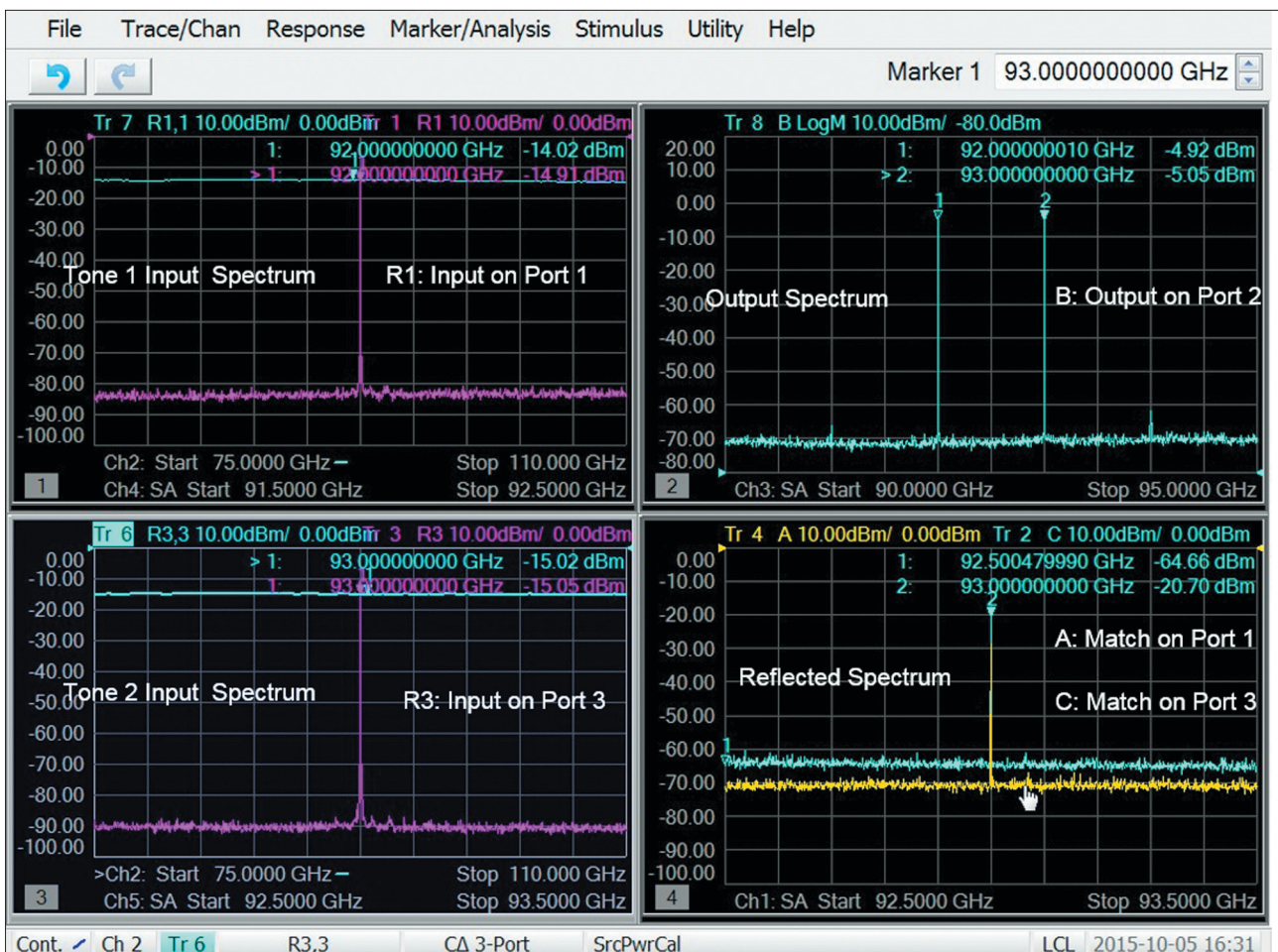
▲ Рис. 4. Многоканальные измерения в режиме анализа спектра без переподключения позволяют выполнять точные одновременные измерения на всех портах ТУ
