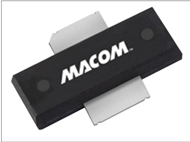
▲ Рис. 2. В пластиковом корпусе TO272S возможна компоновка, характерная для корпусов типа TO272, но без винтового крепления за «ушки». Благодаря улучшенным тепловым характеристикам, такой транзистор способен выдать до 300 Вт пиковой мощности
