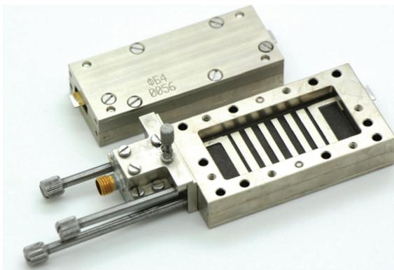
▲ Рис. 3. Конструкция фильтра с контактным устройством
