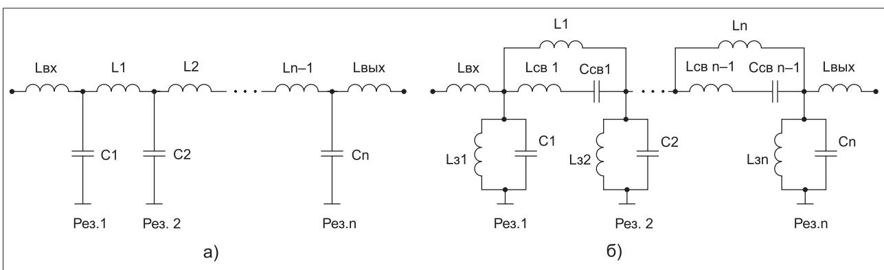
▲ Рис. 2. Эквивалентные схемы фильтров: а — ФНЧ, б — ВГФ
