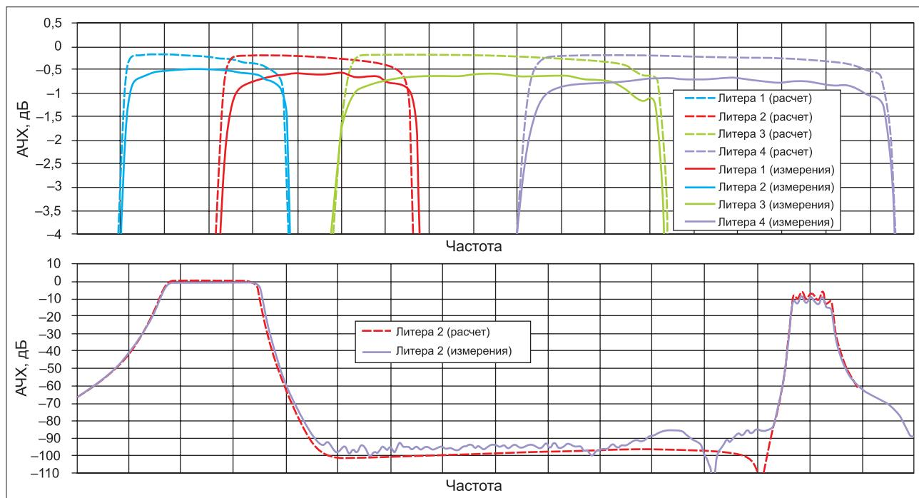
▲ Рис. 5. Сравнение расчетных и измеренных характеристик ВГФ четырех литер. Приведены результаты измерений без учета потерь в контактных устройствах
