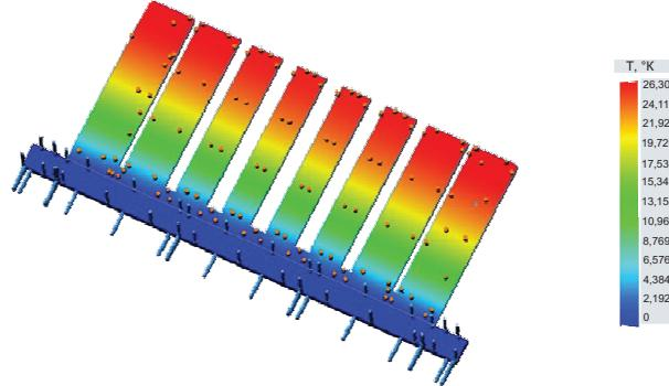
▲ Рис. 4. Термовый расчет рассеивания тепла одной гребенки фильтра на стенку волновода
