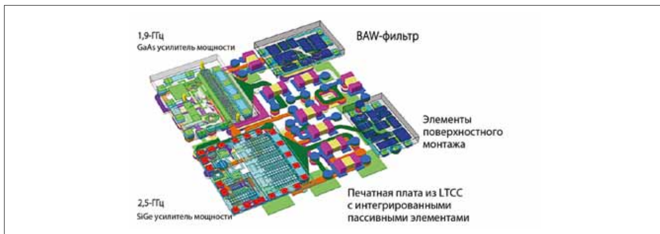
▲ Рис. 2. Двухдиапазонный WLAN T/R-модуль с подключением к антенной решетке, выполненный с применением сразу нескольких технологий
