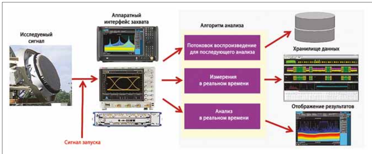
▲ Рис. 4. Функциональные блоки процесса измерений параметров импульсов или сигнальной обстановки. Поскольку результатом захвата сигнала является набор цифровых выборок, сигнал можно записать в хранилище данных для последующей (или повторной) обработки
