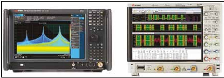
▲ Рис. 2. Анализаторы сигналов и осциллографы — основные аппаратные платформы для измерения параметров импульсных сигналов на ВЧ и СВЧ. Осциллографы обеспечивают более широкую полосу пропускания, но имеют худшие показатели по разрешающей способности и возможностям измерений нелинейных искажений. Современные анализаторы сигналов обеспечивают лучшие характеристики в полосе частот анализа до 1 ГГц
