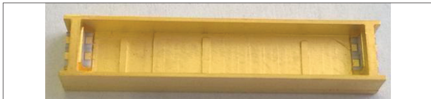
▲ Рис. 3. Металлокерамический корпус транзисторного усилителя мощности
