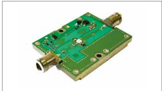
▲ Рис. 18. Демонстрационный широкополосный усилитель мощности УМП2740-10Д на транзисторе ПП9137А
