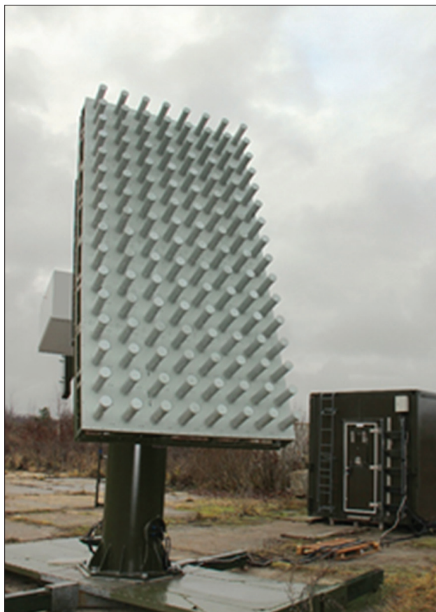
▲ Рис. 1. АС на основе ФАР со встроенным цифровым приемником
