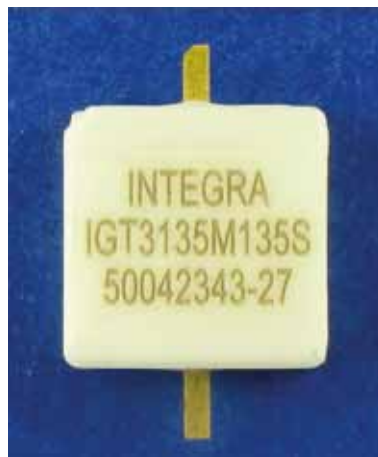
▲ Рис. 2. 135-Вт внутренне согласованный к 50-Ом GaN-транзистор S-диапазона, работающий в полосе частот 3,1–3,5 ГГц. Размеры корпуса: 0,4'×0,4'
