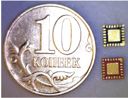
а) МШУ в корпусе SMD (вверху — корпус на основе ПАП, внизу — металлокерамический)
