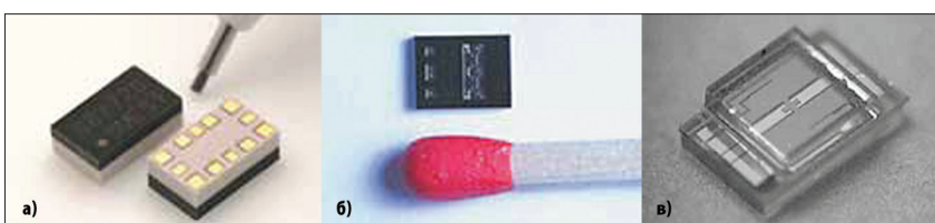
▲ Рис. 25. Корпусированные МЭМС-переключатели: а) 2SMES-01 с электростатическим приводом фирмы Omron; б) с пьезоэлектрическим приводом фирмы Advantest; в) МЭМС-переключатель фирмы Omron, герметизированный стекляннной пластиной [12]
