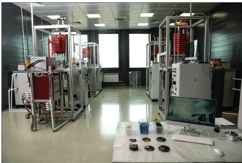
▲ Рис. 3. Установки объемного роста монокристаллов карбида кремния
