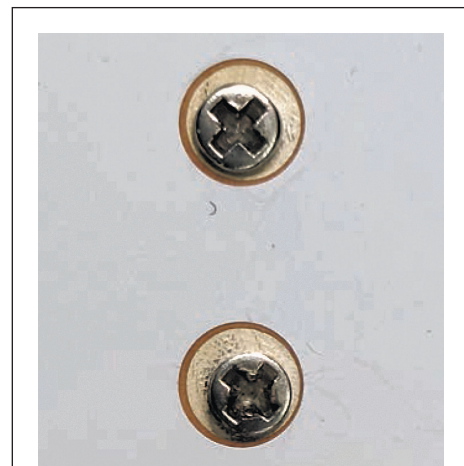
Рис. 1. Потенциальные проблемы с допуском, возникающие при выравнивании винта или штифта с механически выполненными отверстиями в печатной плате
