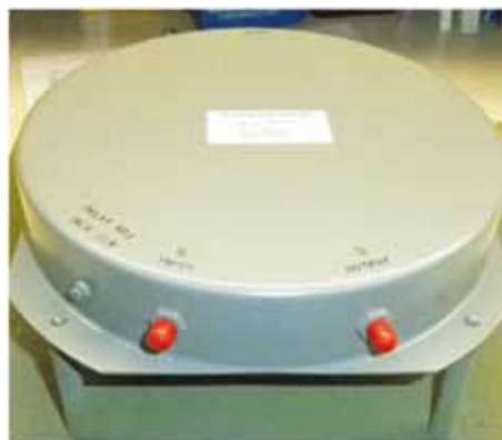
▲ Рис. 1. Коаксиальная ЛЗ производства компании API Technologies
