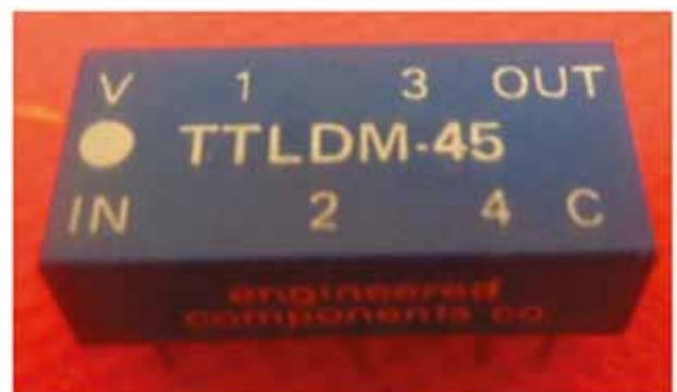
▲ Рис. 20. Активная ЛЗ компании EC2 для TTL-сигналов
