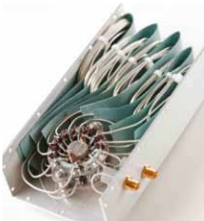
▲ Рис. 9. Переключаемая ЛЗ компании API Technologies
