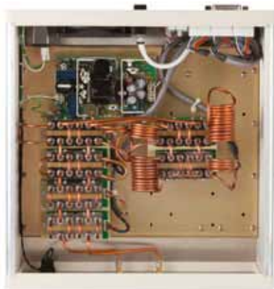
▲ Рис. 23. ЛЗ с релейной коммутацией модели CPDL-100A производства Colby Instruments
