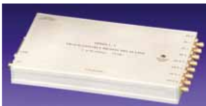
▲ Рис. 30. Четырехканальная программируемая УЛЗ модели QPDDL5 компании GigaBaudics
