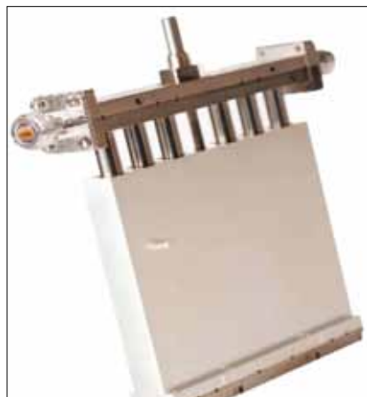
▲ Рис. 6. УЛЗ модели 6804 на основе многосекционного тромбона компании API Technologies
