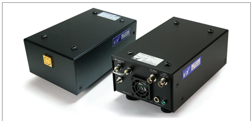
▲ Рис. 4. Передняя и задняя панели расширителей SGX компании Keysight
