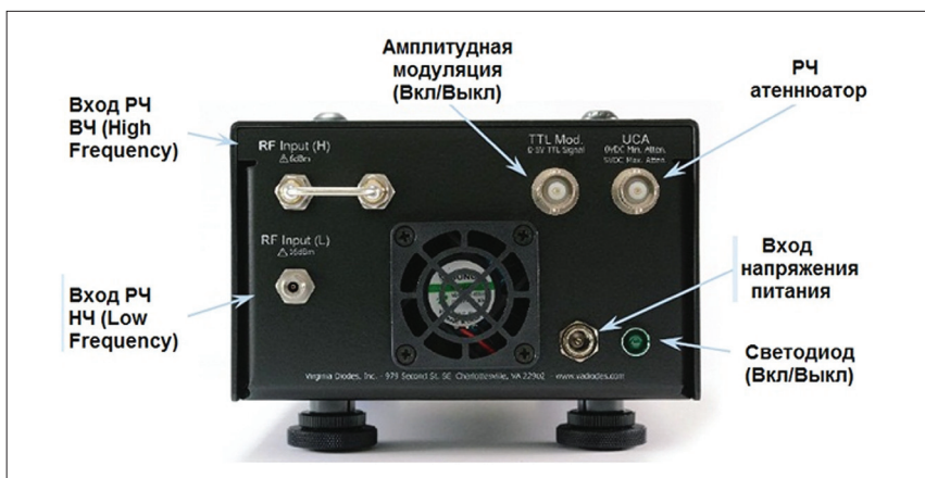
▲ Рис. 5. Задняя панель расширителя серии SGX компании Virginia Diodes
