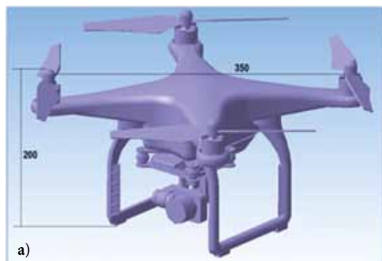
▲ Рис. 3. Трехмерные модели квадрокоптера Phantom 3 (а) и БЛА RQ-11Raven, построенные в программе «Компас-3D» (б)
